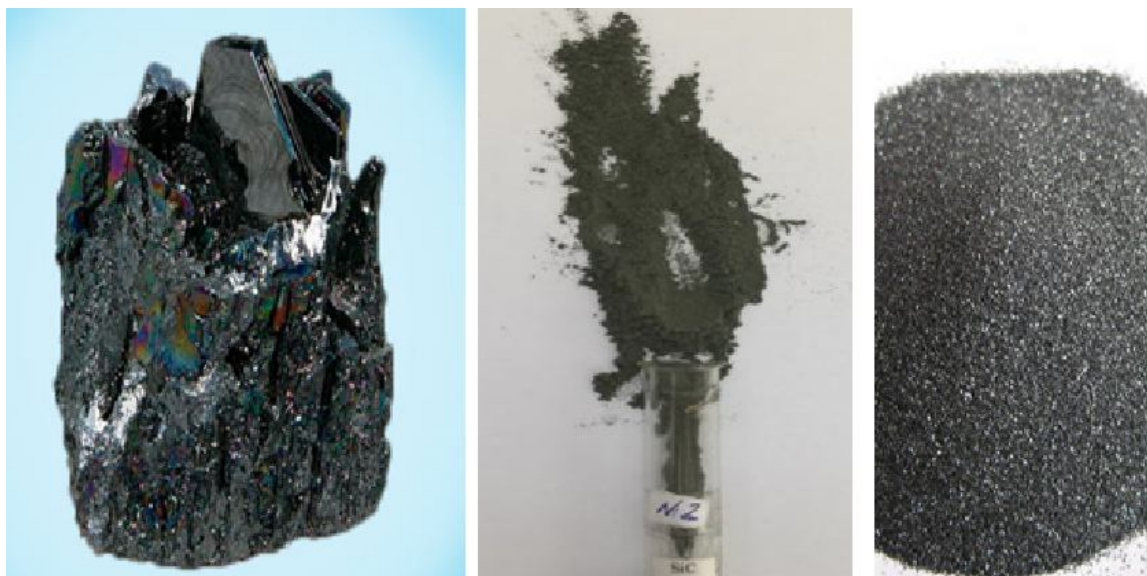
Рисунок 3 – Кусковой КК после печи Ачесона (слева) и порошок КК после реактора ЭТКС (в центре и справа)
